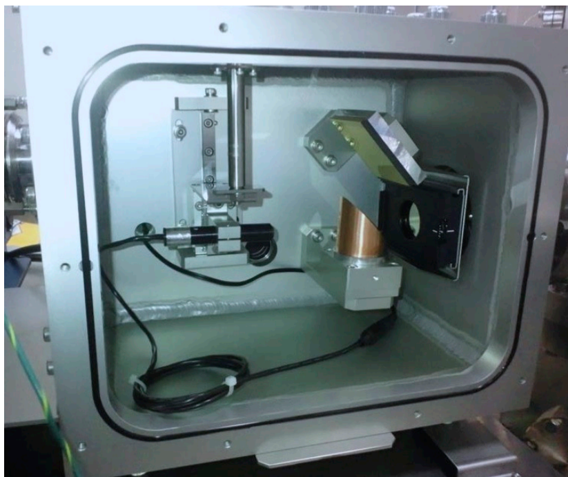
図 3.4 導入光学系内部。図左側に FTIR 光度計，右側に試料室。
