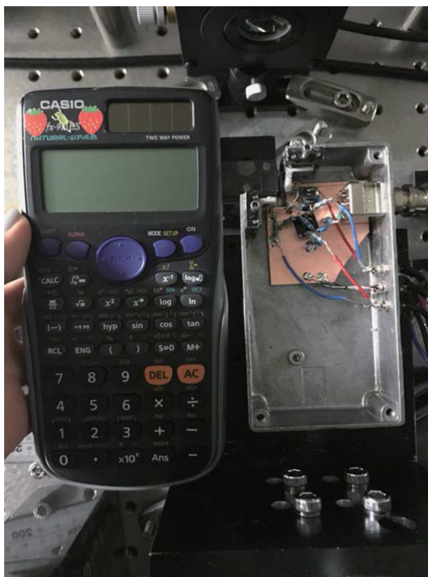
図 4.2: 自作したホモダイナ検出器の全体図. 関数電卓は大きさの比較用.
