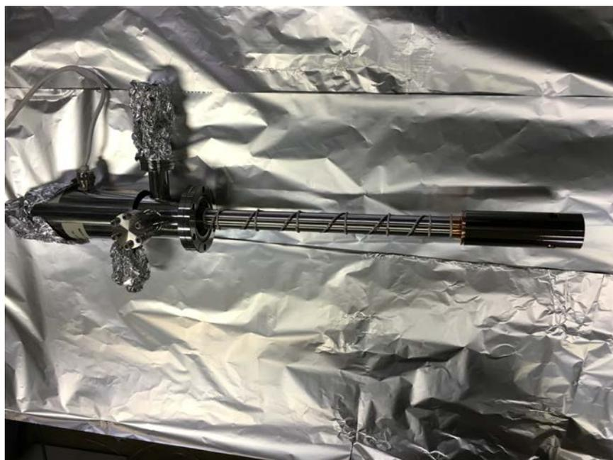
図 5.8: 液体ヘリウム連続フロー式クライオスタットの外観.
