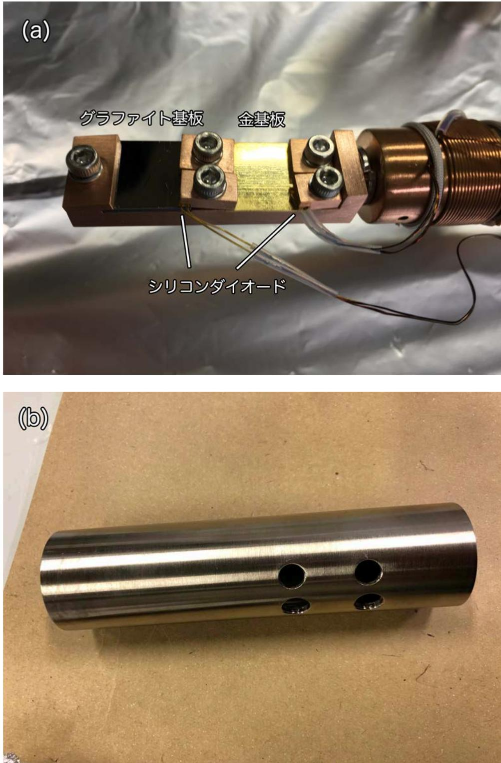
図 5.11: (a) ダブル試料ホルダーと (b) 輻射シールド.
