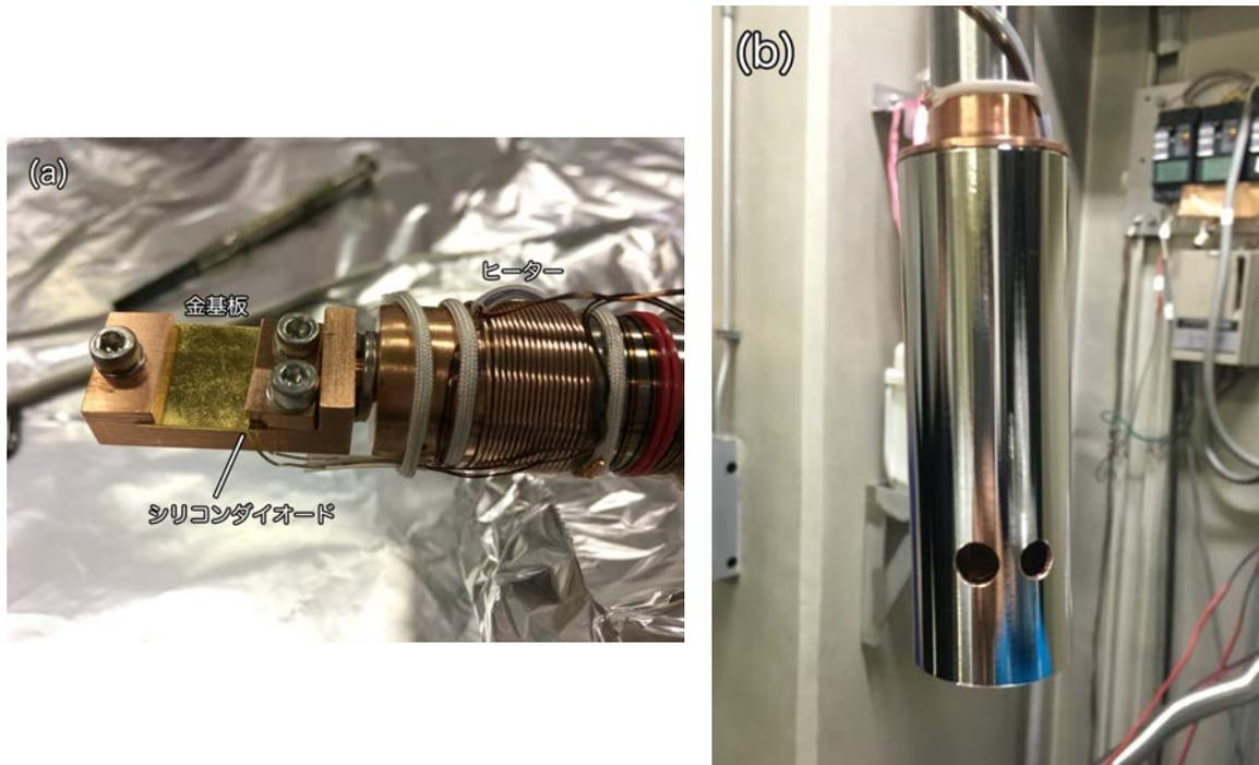
図 5.10: (a) シングル試料ホルダーと (b) 輻射シールド.
