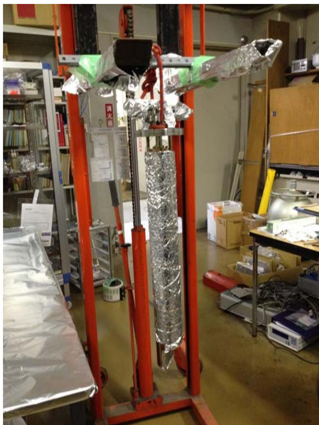
図 5.7: 液体ヘリウム溜め込み式クライオスタットの外観.
