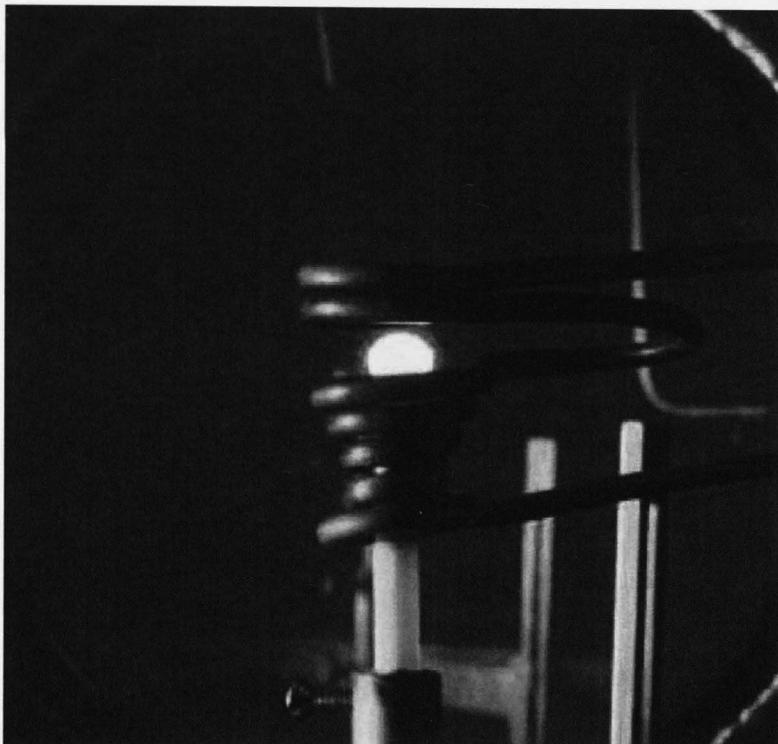
図 2-2：地上用電磁浮遊コイル。上下のコイル間のギャップ部分で白熱しているのが電磁浮遊中の金属液滴である。
