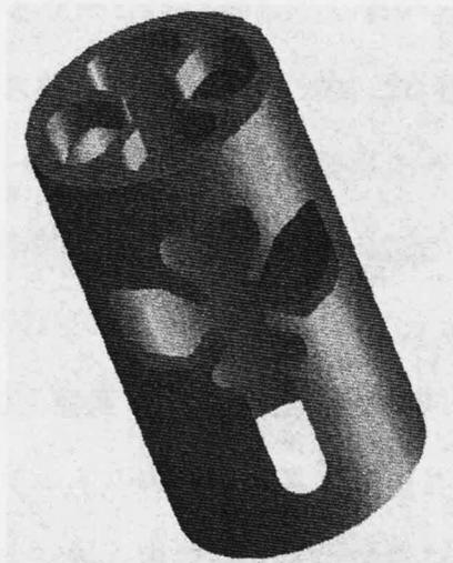
図 3-4 : 試料とコイルとの接触を防ぐケージ (3D モデルによるデザイン図)
