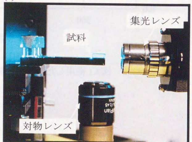
図3.2 新しく作製した光散乱トモグラフィシステム (a)システムの全体図、(b)・(c)試料観察部
